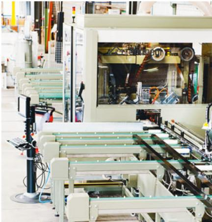
Die Mitarbeiterinnen und Mitarbeiter der Produktion Fenster und Türen können auf dem neuen Bearbeitungszentrum Aluminium-Profile in einem Schnitt zuschneiden und bearbeiten.
